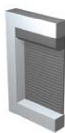
Встроенный монтаж, короб снаружи
