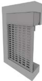
Накладной монтаж, короб внутри
