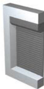
Встроенный монтаж, короб снаружи
