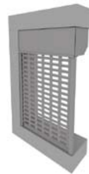
Встроенный монтаж, короб внутри
